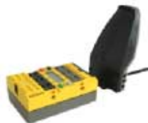
Рис. 11. Запись программы в блок RCX
